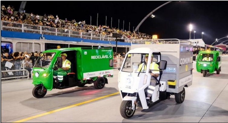
Figura 6: Triciclos para coleta de resíduos 100% elétricos
